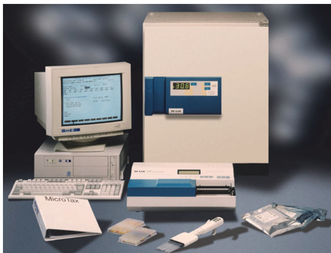
Рис. 7. Общий вид комплекса приборов, системы автоматической идентификации микроорганизмов и определения чувствительности к антибиотикам Micro Tax SY-LAB , Австрия (Идентификационные планшеты, планшеты Micro Tax S для определения чувствительности к антибиотикам, персональный компьютер, программное обеспечение, 8-канальный фотометр для планшетов Micro Tax Reader MT-1 , 8-канальная электронная пипетка, инкубатор MT-5 ).
