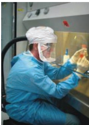
Рис.5. Защитный колпак с принудительной подачей воздуха.
