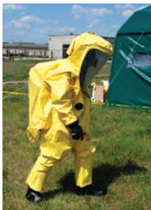
Рис.1. Костюм изолирующий с автономным обеспечением подачи воздуха.
