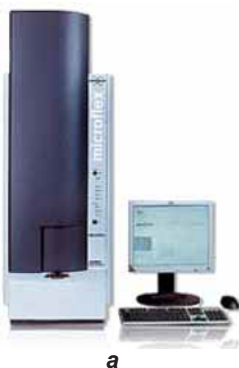
Рис. 9. Масс-спектрометр Microflex™ (а) и образец масс-спектра, полученного при идентификации культуры V. cholerae (б).
