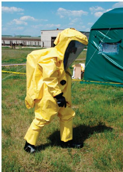
Рис. 3. Костюм изолирующий с автономным обеспечением подачи воздуха.
