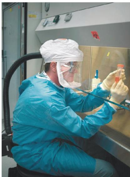
Рис. 7. Защитный колпак с принудительной подачей воздуха.
